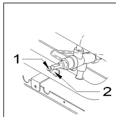
Fig. – Abb. 10: Verifica della tenuta e della pressione di alimentazione \ Contrôle de la tenue et de la pression d'alimentation \ Checking gas tightness and pressure \ Überprüfung der Dichtigkeit und des Versorgungsdrucks \ Comprobación de la estanqueidad y de la presión de alimentación
