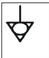
Fig. – Abb. 9: Simbolo equipotenziale \ Symbole equipotenzial \ Equipotenziale label \ Áquipotenzial Symbol \ Equipotenzial símbolo
