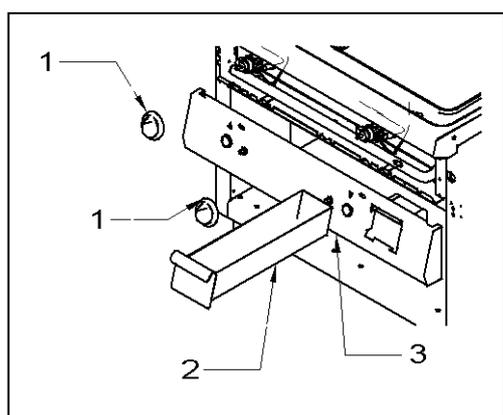
Figg.. – Abb. 11 :\_Sostituzione ugello bruciatore \ Changement du gicleur du brûleur \ Substituting the burner nozzle \ Austausch der Hauptbrennerdüse \ Cambio boquilla quemador
