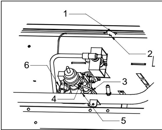
Fig.-Abb. 19 : Sostituzione termostato in sicurezza \
